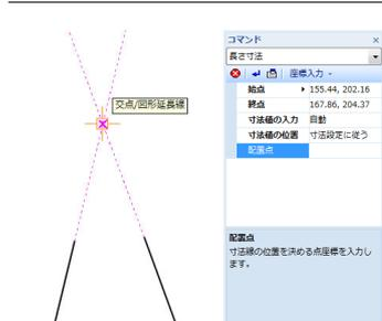
図面上の点を指定するための仮想交点スナップ、作図原点、グリッドなど、スピーディーに作図するための補助機能も充実しています。
